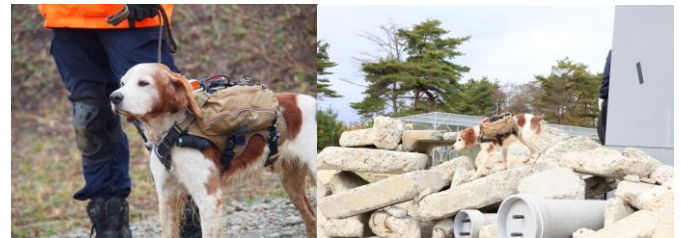
図 1. サイバー救助犬: 体重の 10%未満のサイバースーツを身につけた救助犬 (日本救助犬協会 ゴン太) の瓦礫探索
